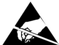
Die in der Konstruktion des Schreibers verwendeten Halbleiterelemente oder die mit dem oben dargestellten Symbol gekennzeichnete Pakete, können infolge elektrostatischer Entladung beschädigt werden.
