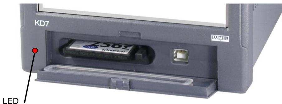
Nach Überschreitung von 90 % des Speicherplatzes auf der CF Karte (die Ikone der CF Karte auf dem Display ist rot) **wird empfohlen**, die Daten möglichst schnell von der Speicherkarte auf den internen Speicher des PC Computers zu übertragen, die Karte zu formatieren oder durch eine andere, die nicht beschrieben und formatiert wurde, zu ersetzen (siehe Abschnitt 8.1.2).
