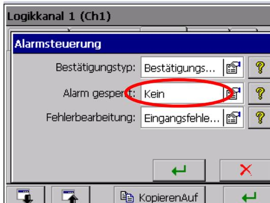
Analoger Ausgangswert des Logikkanals **größer** als die Null wird als logischer Zustand 1 (ON) des bestimmten Kanals interpretiert.
